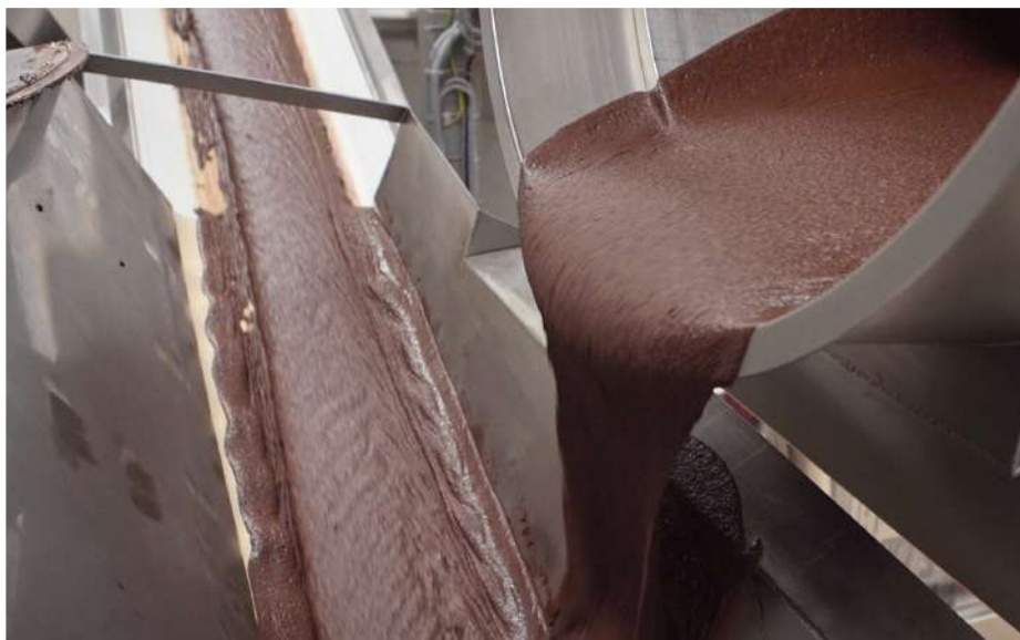
La miscela grezza deve essere rimacinata in una rullatrice, a cui viene inviata tramite un nastro trasportatore
