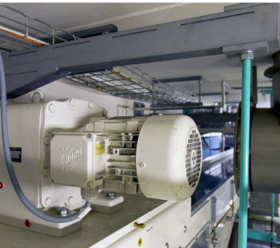
L'azionamento a nastro durante il carico della temperatrice
